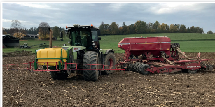
Aplikátor na bakteriální hnojiva Azoter v agregaci se secím strojem
